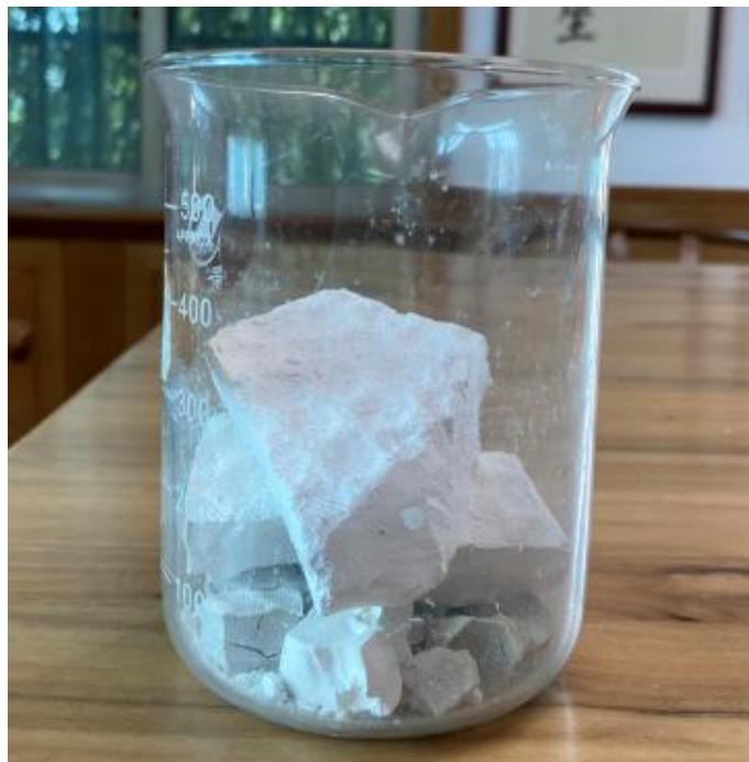
图 2-2 本项目含铝污泥进厂照片
