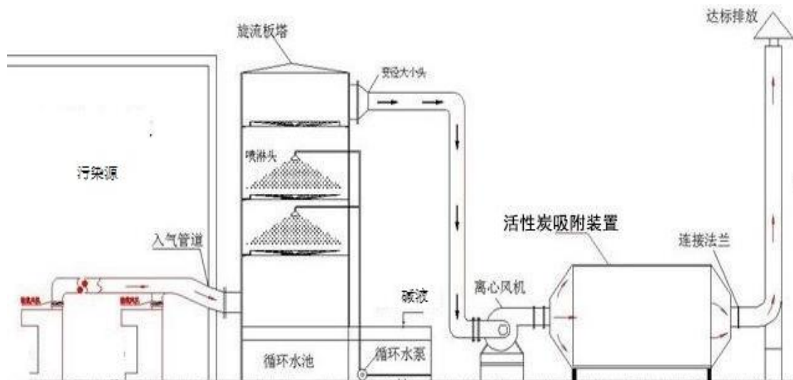
图 8.2-2 喷淋+活性炭吸附装置示意图
