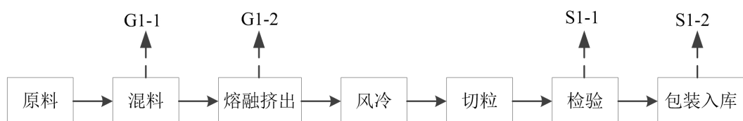
图 2-5 造粒制品生产工艺流程图
