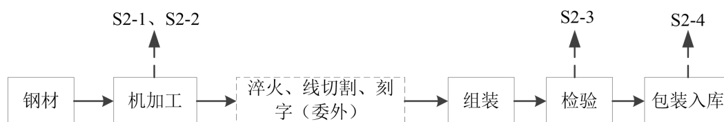
图 2-6 模具、五金件生产工艺流程图
