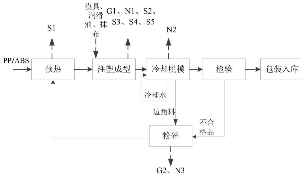
图 2-3 注塑件生产工艺流程图
