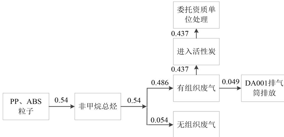
图 2-1 本项目 VOCs 平衡图
