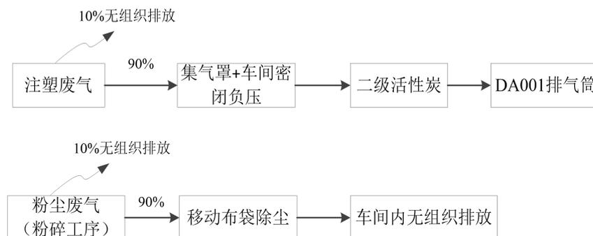
图4-1 废气收集、处理、排放流程图
