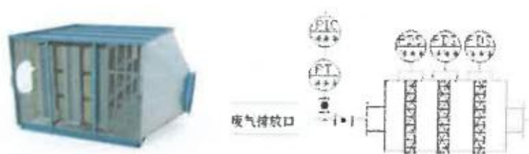
图 6.2-2 干式过滤器示意
