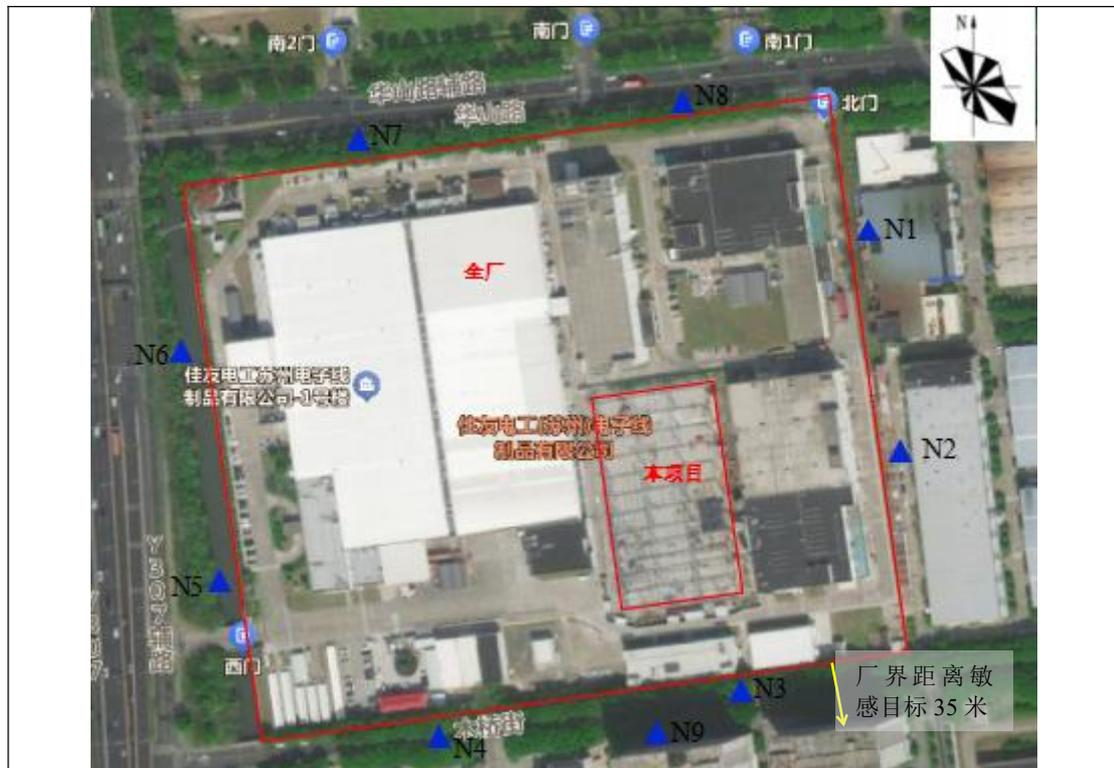
噪声监测点位示意图（注：▲代表噪声监测点位）
