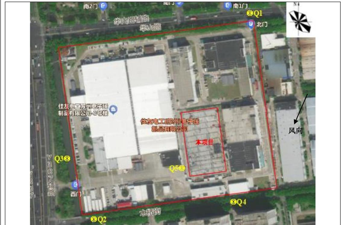
废气无组织监测点位示意图（注：○代表无组织监测点位）
