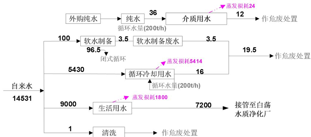
图 2-1 本项目水平衡图 (t/a)
