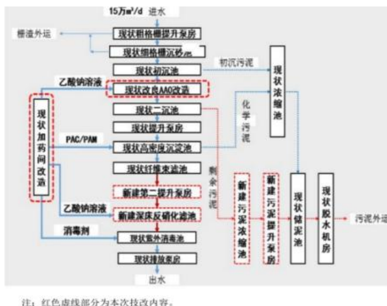
图 4-3 城南污水处理厂废水处理工艺流程图
