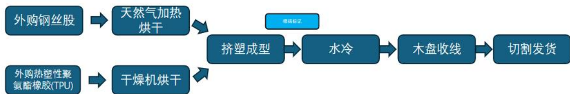
图 2-3 裹塑钢丝绳生产工艺流程图
