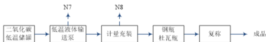
图 3.3-3 二氧化碳充装工艺流程图
