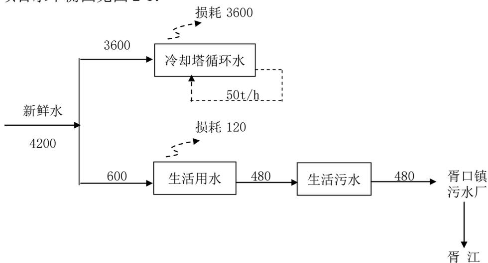
图 2-1 本项目水平衡图 (m<sup>3</sup>/a)
