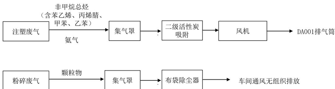
图 4-1 废气收集处理工艺流程图
