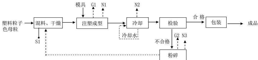
图例：G—废气； N—噪声； S—固废
