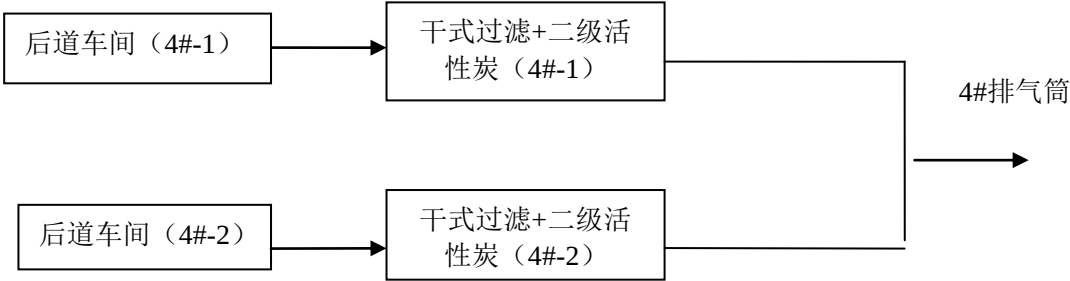
图 4-3 现有项目 4#排气筒处理设施情况
