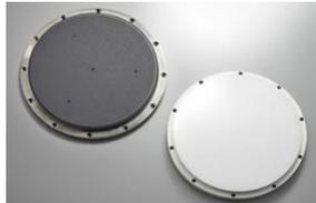
②陶瓷加热器，主要应用于半导体薄膜沉积设备、激光退火设备的工艺腔室内，与晶圆直接接触，承载并使晶圆获得稳定、均匀的工艺温度及成膜条件。陶瓷加热器可实现均匀温度分布，对晶圆均匀加热，使衬底表面上进行高精度的反应并生成薄膜。
