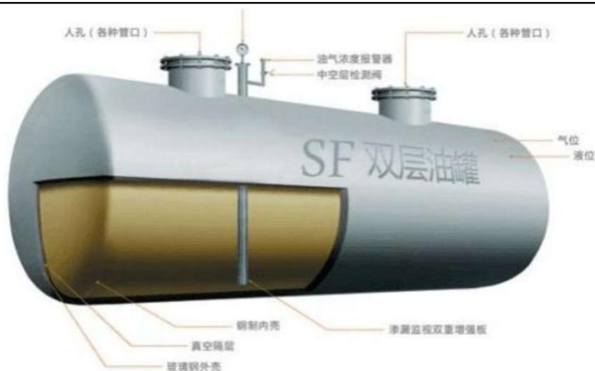
图 2-8 SF 双层油罐构造
