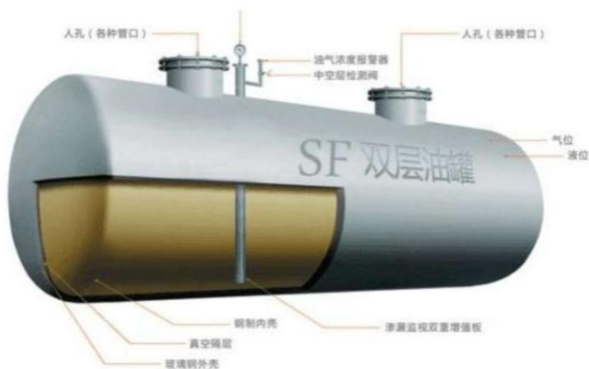
图 2-8 SF 双层油罐构造
