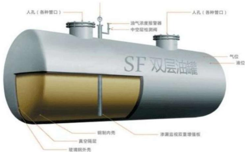
图 2-8 SF 双层油罐构造
