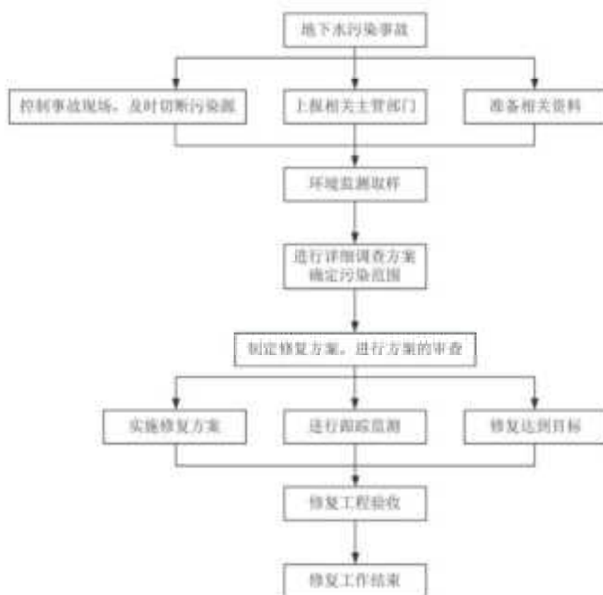
图 7.5-3 地下水污染应急治理程序框图
