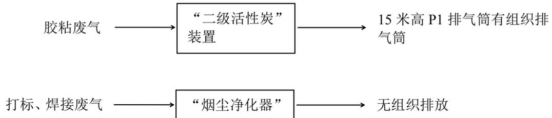
**图 4-1 废气收集处理流程图**
