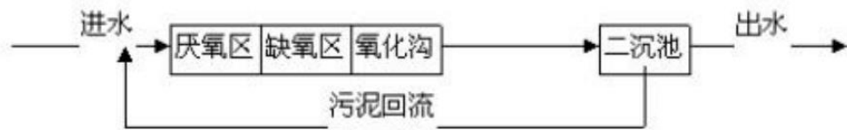
图 4-3 改良型氧化沟工艺流程框图
