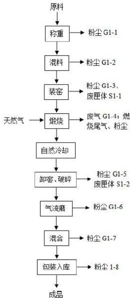
图2-2 陶瓷色料生产工艺流程及产污环节图
