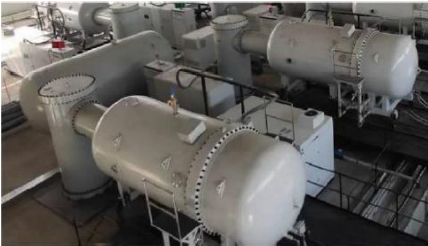
图 9-1 卧式工业电子加速器主机钢桶
