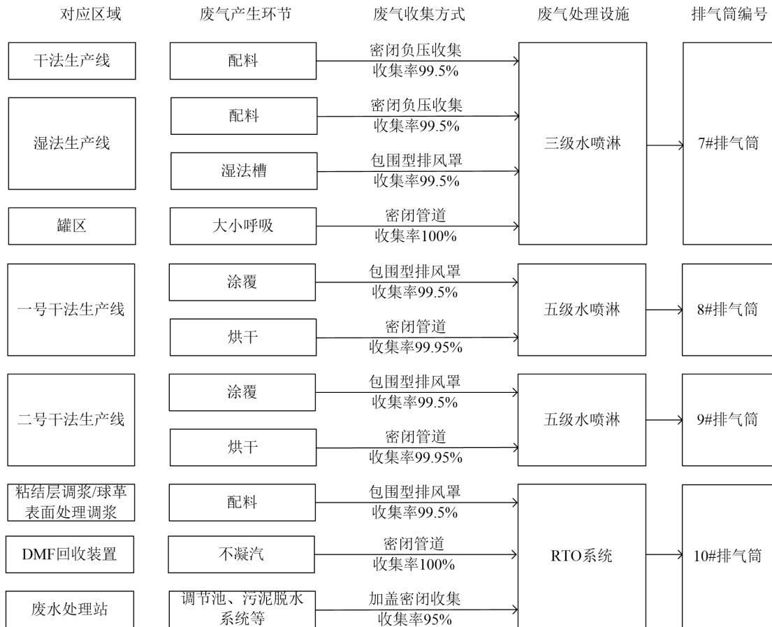
图 7.1-1 废气处理工艺流程图
