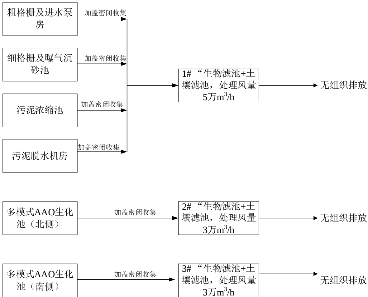
图 6.1-5 除臭工艺流程图
