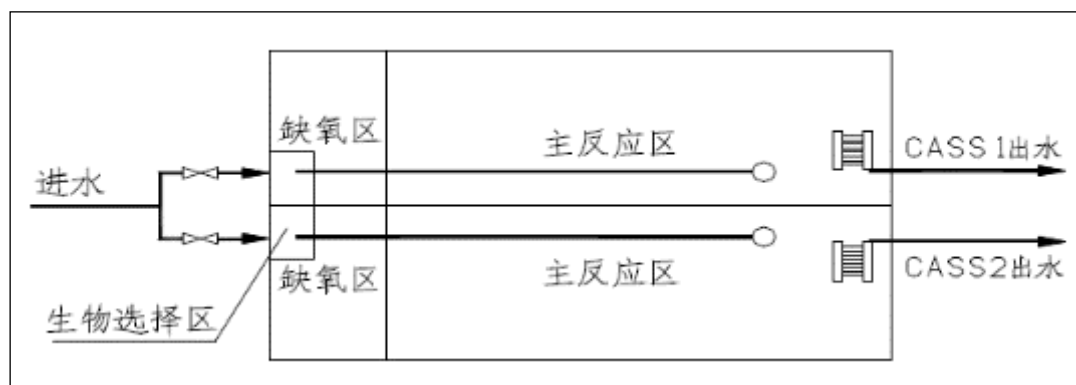
图 3.4-6 CASS 工艺平面示意图
