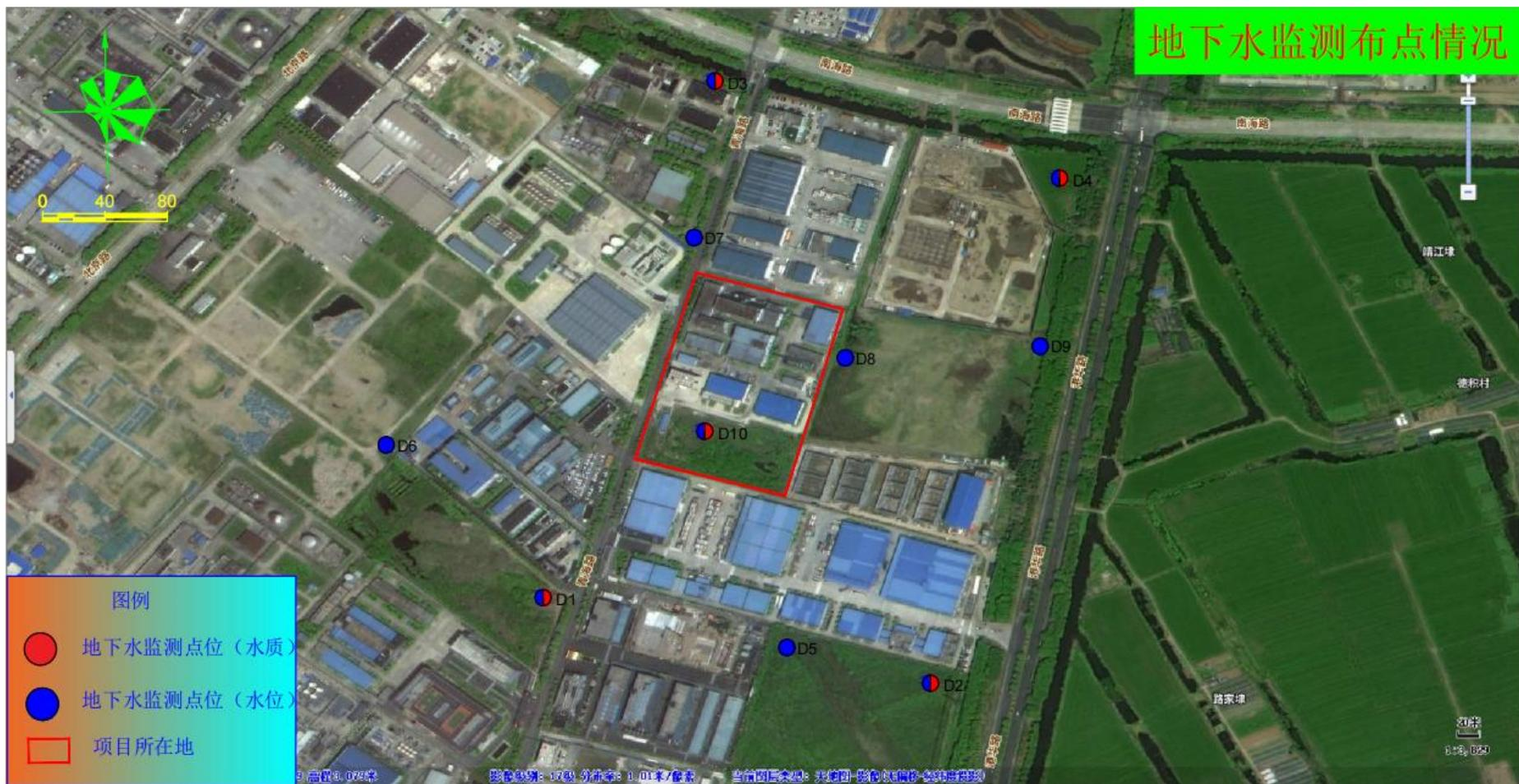
图 22 地下水水质及水位监测点位示意图
